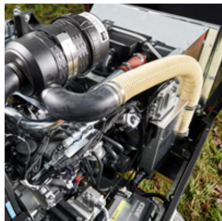
Hatz 4H50 Stage V motor med 55 kW
