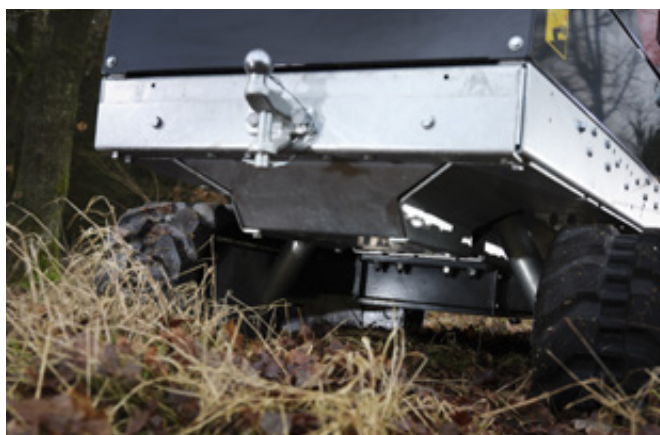
Største frihøjde på markedet: 250 mm, nem service og solid slangeafdækning. Variabel bæltebredde.
