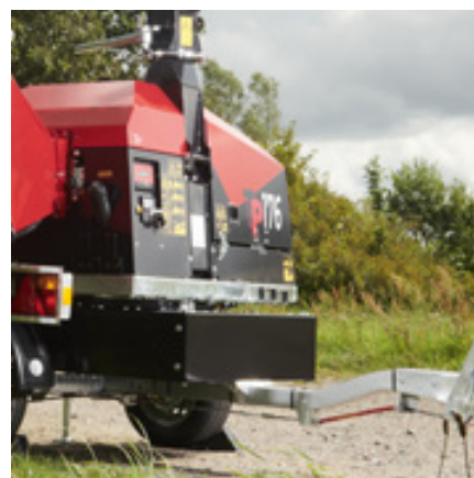
220° drejekrans er tilvalg (øger vægten 80 kg)
