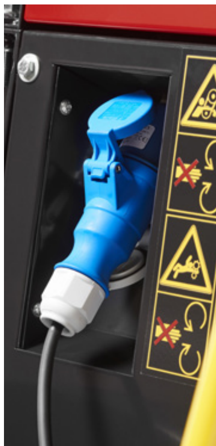
Integreret lader: 230V 16A 65V og kabel
