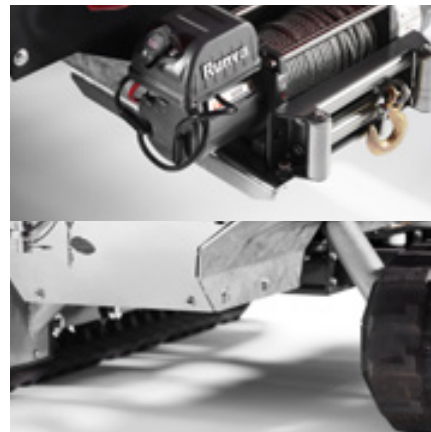
Elektrisk spil kan anvendes, når flishuggeren skal op eller ned af skråninger. Største frihøjde på markedet: 200 mm. Variabel bæltevidde: 1150-1300 mm. Forstærket beskyttelse af hydraulikslanger.
